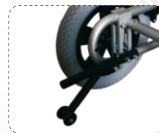
Ruotine antiribaltamento ribaltabili ed estraibili
